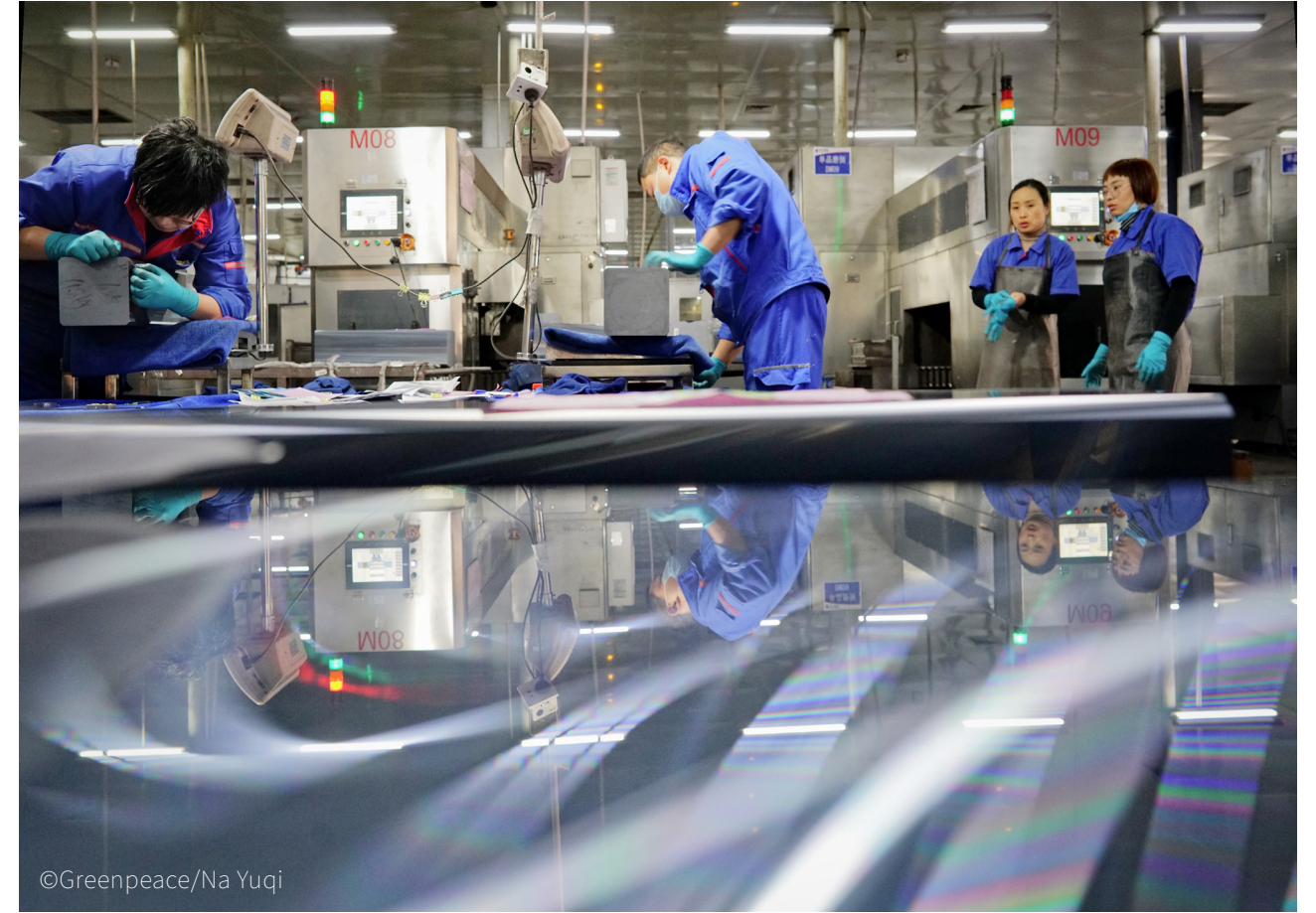
某光伏产品配件车间内，工人正在对成型的硅材料进行精密切割，制成超薄硅片。
